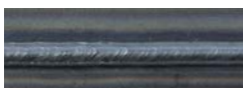
溶接電流：40A、溶接電圧：16V、溶接速度：50cm/min、ワイヤ径：1.2mm（ソリッドワイヤ）
