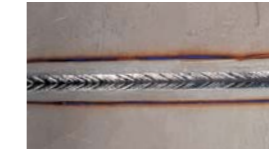
板厚:2mm, 溶接電流:120A, パルス周波数:5Hz
