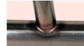
板厚:2mm, 溶接電流:150A, パルス周波数:10Hz
